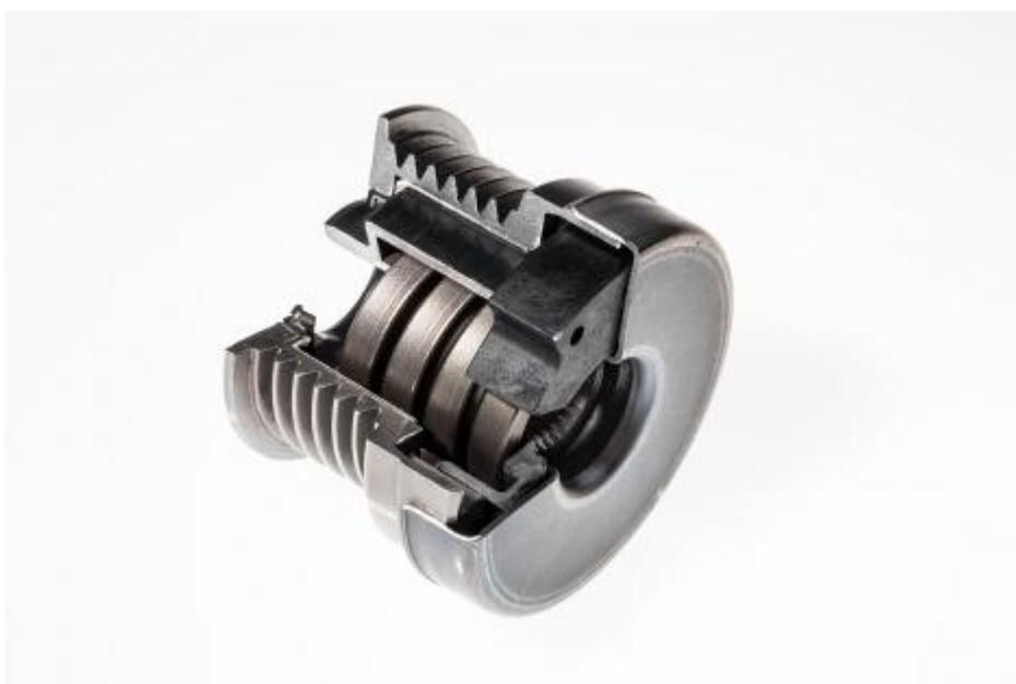
Notre solution associe une DAP et une courroie élastique, afin de transmettre la puissance depuis le moteur vers les différents accessoires de la façade de transmission. Elle permet de simplifier l'architecture de cette façade en supprimant un ou plusieurs galets, ainsi que le tendeur automatique.
