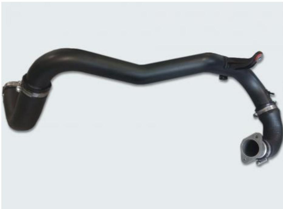
Hutchinson produit des boucles complètes pour le circuit d'admission d'air turbo. Nos produits intègrent des raccords en élastomère et des tubulures plastiques. Nous possédons un savoir-faire particulièrement reconnu dans la « partie froide » qui relie le Refroidisseur d'Air Suralimenté du véhicule à la vanne d'alimentation d'air du moteur. Cette pièce est obtenue par extrusion-soufflage. Notre solution se distingue par une excellente résistance thermique et chimique et un faible poids.
