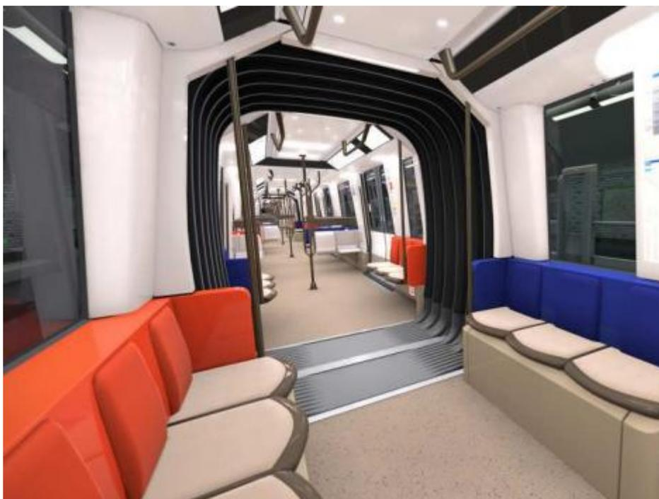
Notre Intervehicule Gangway permet de circuler en toute sécurité entre les voitures d'un véhicule ferroviaire ou entre les différentes parties d'un tramway. Ses points forts : un haut niveau d'insonorisation et de protection contre le feu, ainsi qu'une excellente résistance à un usage intensif.
