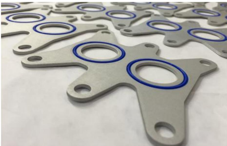
Cette conception de joint permet de séparer les fonctions d'étanchéité et de serrage. Le montage est facilité, le joint est plus robuste et sa durée de vie est augmentée. Le choix des mélanges et des matériaux d'armatures, autorise l'usage dans des conditions extrêmes de fonctionnement et ce sans compromis sur le poids. Notre joint à armature est homologué pour des applications industrielles, aérospatiales et militaires.
